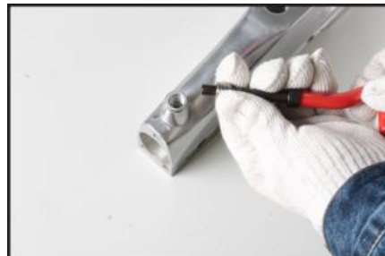
3. Włóż zwiniętą wkładkę do aplikatora.
