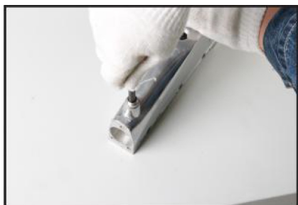
4. Wkręć adapter do nagwintowanego otworu.
