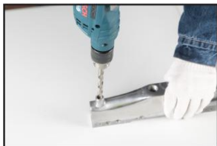
1. Przewierć uszkodzony gwint wiertłem o odpowiednim rozmiarze.
