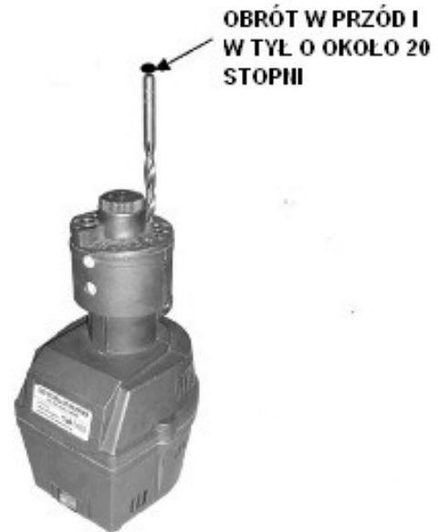
RYSUNEK 2 - UMIESZCZENIE WIERTŁA W OSTRZLCE
